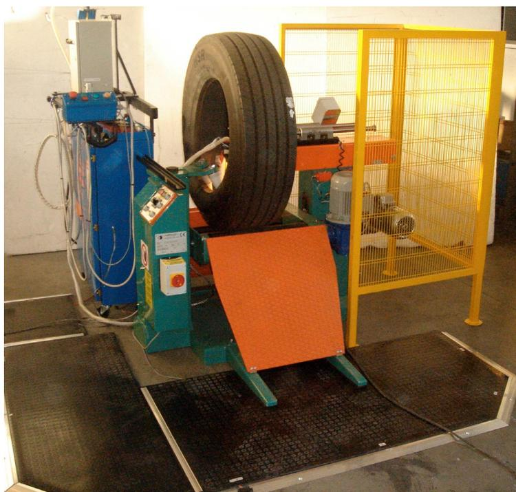
**Spectra** è uno strumento per rilevare fori passanti causati nei pneumatici da chiodi, tagli, lacerazioni interne, porosità o riparazioni difettose. L'ispezionatrice **540/2** & **Spectra** sono indispensabili per l'ispezione iniziale, quella finale e per le stazioni di riparazione.
