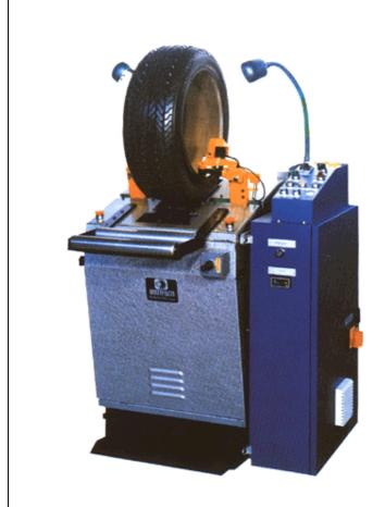
Le ispezionatrici sono state studiate dalla Matteuzzi per facilitare le operazioni di ispezione visiva dell'interno e dell'esterno del pneumatico.
